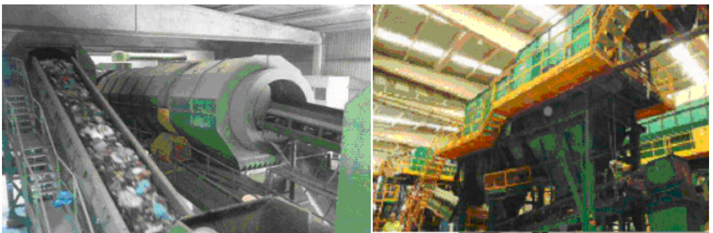
Ilustración 5. Plantas de tratamiento mecánico-biológico de residuos domésticos en Extremadura. Tromel línea EELL y todo uno, a la izquierda y separador balístico línea EELL a la derecha.
