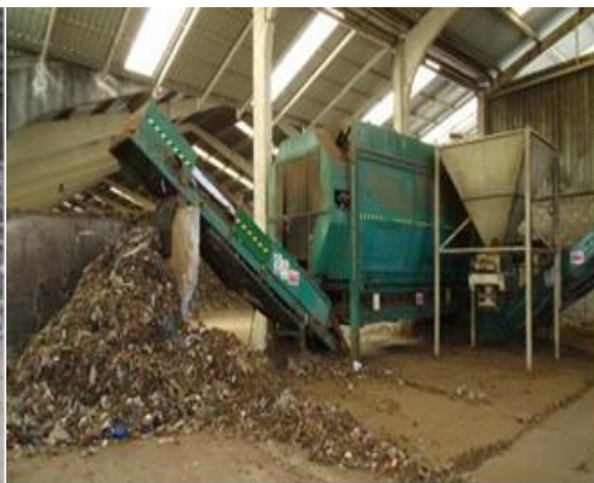
2. Trómel de la planta de afino desechando el rechazo.
